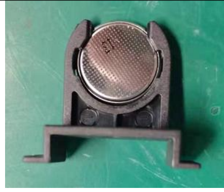
电池支架和电池组件
